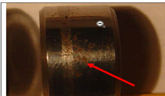
Fig. 3- Vista del daño en la superficie externa de los cojinetes. El daño ha ocurrido por un mecanismo de fatiga de contacto en la región que contacta la leva sobre la superficie de los cojinetes. Son visibles marcas de desgaste adhesivo, con fisuras y desprendimientos de material asociados a estas, atribuibles al efecto de altas cargas específicas que actuaron sin una óptima lubricación sobre la superficie del material que parece haber tenido suficiente dureza: Notar también la corrosión (flecha).
